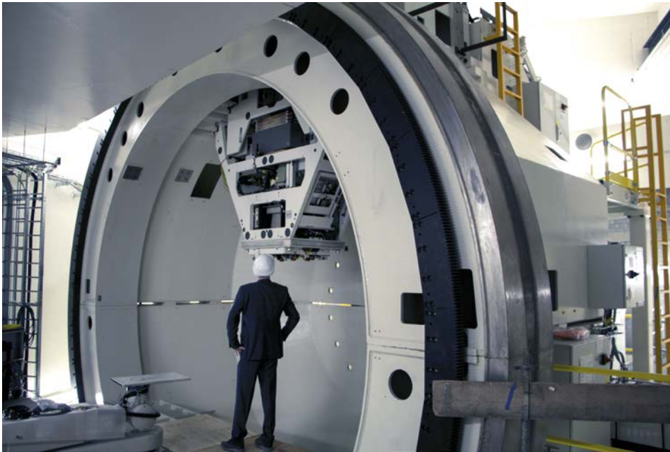
Een van de twee 360 graden roterende Gantries, waarmee bestralingen op elk gewenste plek uitgevoerd kunnen worden.
